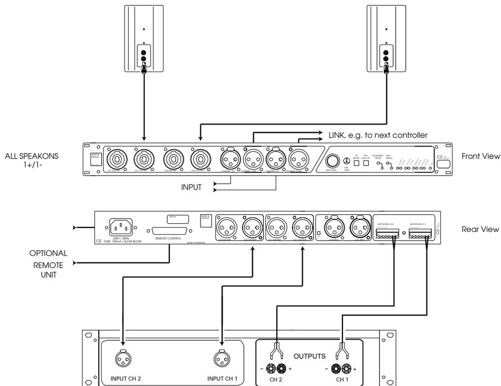
Der versenkte Schalter ‚Fullrange Mode‘ am C2 Controller sollte gedrückt sein, die dem Schalter zugeordnete LED, muss somit leuchten. Der Fullrange Schalter hebt den Bassbereich der Mittelhochton-Systeme an, so dass auch Musikprogramm ausgewogen übertragen werden kann.
