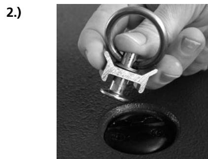
... und drücken Sie die Arretierung gegen die Federspannung nach oben.
