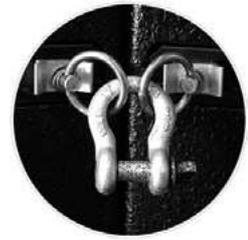
Eine 'allsafe JUNGFALK' Flugschiene darf maximal mit 73 kg belastet werden. Daher muss die Last beim Abspinnen der Systeme auf mehrere Flugschienen verteilt werden.
