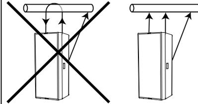
Die Sicherungsseile mehrerer Systeme müssen immer an einem Punkt zusammengeführt werden.
