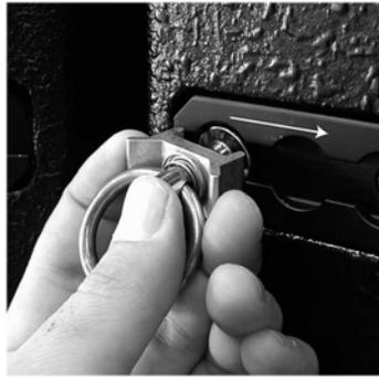
Führen Sie den Flachkopf des Haltebolzens in die Führung der Flugschiene und schieben Sie die Zurröse seitlich in die Flugschiene.
