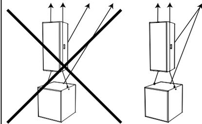
Das Gewicht des untergehängten Lautsprechers darf maximal 73 kg betragen (das entspricht in etwa dem Gewicht einer SW 215E-SP).
