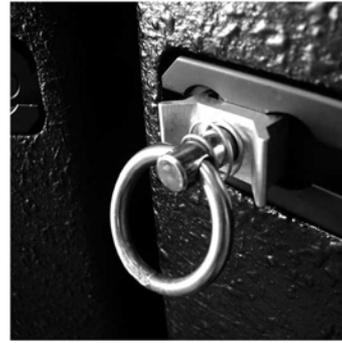
Lassen Sie die Arretierhilfe los, wenn sich die Zurröse über den Zungen befindet. Achten Sie darauf, dass die Arretierhilfe einrastet. Und überprüfen Sie unbedingt den festen Sitz.
